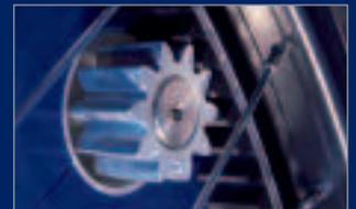
Cambio sencillo entre tracción a motor o manual mediante acoplamiento o desacoplamiento neumático de los engranajes en los anillos dentados de su silla.
