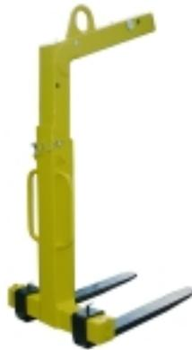
Porta-paletes com equilibrado automático em função do peso. Garfos móveis desde 500 até 1.000 mm, para a elevação de cargas até 5.000 kg, perfeito para transportar todas as mercadorias sobre paletes a través duma grua. Fabricado em aço muito resistente.
