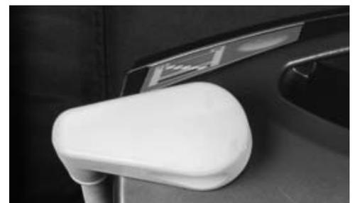
Después se enchufa el conector de la línea de energía ❶ en el casquillo de salida ❷ del paquete acumulador.
