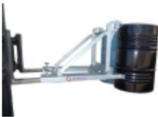
Pinças para o transporte sujeição ou elevação de 2 bidões de 50-200 Litros e não superior aos 500 Kg. Manejo simples e seguro uma vez que possui um garfo especial de sujeição. Possui uma pinça de sujeição regulável em altura para poder adaptar-se aos diferentes tamanhos dos bidões. Estrutura muito robusta fabricada em aço perfilado para ser usado em empilhadores. Marcado CE.
