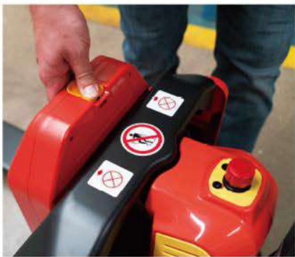
Posicionamiento inteligente de la batería y bloqueo para una gran fijación y seguridad
